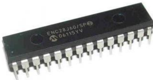
Figura 15.27. Chip ENC28J60 em encapsulamento DIP.
