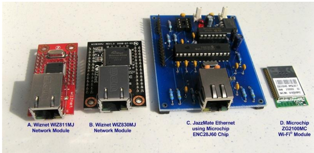
Figura 15.22. Exemplos de placas que utilizam a tecnologia de Internet embarcada.
