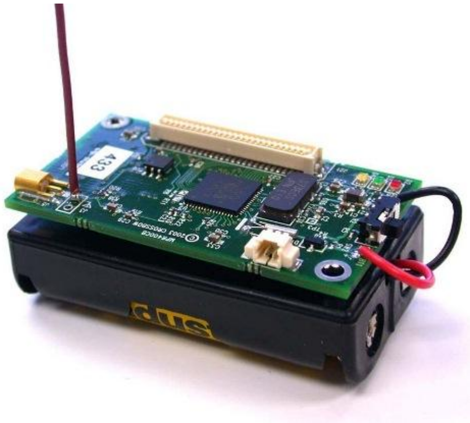
Figura 7.14 Modelo de sensor mica2 da Crossbow
